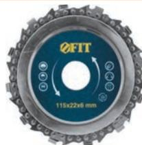
Применяется при резке, фрезеровании, изготовлении гнезд для шипов, моделировании. Посадочный диаметр 22,2 мм. Толщина 6 мм. Материал: высококачественная инструментальная сталь. Упаковка: картонный конверт.
