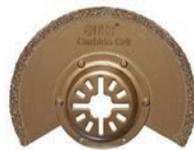
Ступенчатый, карбидный. Диаметр лезвия 85 мм. Для резки бетона и кафельной плитки. Материал: основание из легированной инструментальной стали, режущая кромка содержит порошок из карбида вольфрама. Упаковка: блистер.
