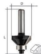
Используется для работ по дереву. С нижним подшипником. Для фрезерования кромок. Угол при вершине 90°. Цилиндрический хвостовик 8 мм. Материал: инструментальная сталь с твердосплавными режущими вставками. Упаковка: двойной блистер.
