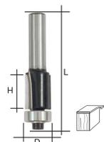
Используется для работ по дереву. С нижним подшипником. Для фрезерования кромок. Цилиндрический хвостовик 8 мм. Материал: инструментальная сталь с твердосплавными режущими вставками. Упаковка: двойной блистер.
