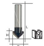
Используется для работ по дереву. Для фрезерования пазов. Угол при вершине 90°. Цилиндрический хвостовик 8 мм. Материал: инструментальная сталь с твердосплавными режущими вставками. Упаковка: двойной блистер.
