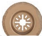
Ступенчатый, карбидный. Диаметр лезвия 64 мм. Для резки бетона и кафельной плитки. Материал: основание из легированной инструментальной стали, режущая кромка содержит порошок из карбида вольфрама. Упаковка: блистер.
