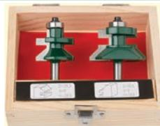
Используется для работ по дереву. Для изготовления профиля и обратного профиля вагонки. Цилиндрический хвостовик - 8 мм. Материал: инструментальная сталь, с твердосплавными режущими вставками. Упаковка: деревянная коробка.
