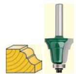
Используется для работ по дереву. С нижним подшипником. Для фигурной обработки декоративных кромок. Цилиндрический хвостовик. Материал: инструментальная сталь, с твердосплавными режущими вставками. Упаковка: пластиковая коробка.
