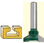
Используется для работ по дереву. Для выборки пазов на кромках и торцах деталей, и для Т-образных соединений. Цилиндрический хвостовик. Материал: инструментальная сталь, с твердосплавными режущими вставками. Упаковка: пластиковая коробка.
