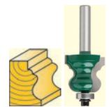
Используется для работ по дереву. С нижним подшипником. Для фигурной обработки декоративных кромок. Цилиндрический хвостовик. Материал: инструментальная сталь, с твердосплавными режущими вставками. Упаковка: пластиковая коробка.
