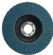
Тип 1 (Плоский). 80 лепестков. Для УШМ. Посадочный диаметр 22,2 мм. Для сухого шлифования и снятия краски с нержавеющей стали, инструментальной стали, чугуна, цветных металлов, пластика, дерева. Материал: абразивный слой - 100% цирконий, основа - х/б ткань, подложка - стекловолокно, обод - инструментальная сталь.
